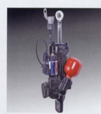
Kabinenfederungs-system mit integrierter Wegmessung und proportionaler Dämpfung
