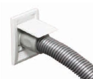
Der flexible Saugschlauch wird ganz einfach in die Wanddose gesteckt. Damit ist der Saugschlauch mit dem Rohrleitungssystem in der Hauswand verbunden, das zur Saugzentrale führt. Eine Turbine in der Saugzentrale saugt den Staub kraftvoll an. Bei Ihnen im Wohnraum bleibt die Luft sauber und der Geräuschpegel niedrig.
