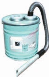
**Ascheabscheider** für den Kamin vereinfachen die Entfernung von Asche und das auch noch komplett staubfrei. Einfach den Saugschlauch in den Abscheider stecken und mit dem am Abscheider angebrachten Schlauch den Kamin freisaugen. Ein eingebauter Filter verhindert, dass der Feinstaub in das Rohrsystem gelangt. Perfekt auch zum Absaugen von Schleifstaub, Mehl in Bäckereien oder jeglicher Art von feinem Staub.
