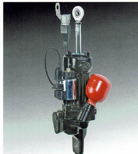
Kabinenfederungssystem mit integrierter Wegmessung und proportionaler Dämpfung
